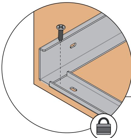
Fijar la base al módulo según el esquema.
