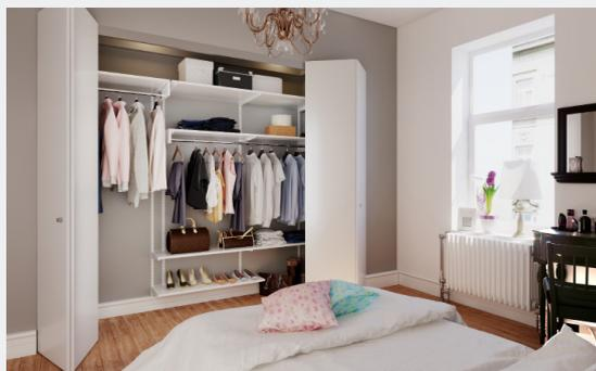
Sistema modular de organización, compuesto por pilares de doble ranura y soportes, ambos fabricados en acero recubierto con pintura epóxica que evita rayaduras y brinda mayor durabilidad. Se fijan gracias a un sistema de enganche, permitiendo graduar la distancia entre repisas sin necesidad de desinstalar los pilares. Fabricado en acero 1.2 mm para los soportes y 1.9 mm los pilares, pintados con terminación epóxica y atractivo acabo brillante
