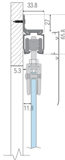
Instalación con conector lateral aM uro
