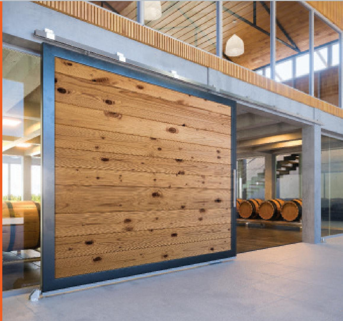
Sistema corredizo colgante con rodamientos revestidos en nylon. Compuesto de 2 correderas de alta resistencia y durabilidad, fabricadas en acero. Testeado para funcionamiento continuo en portones de madera o metal de hasta 300 kg.
