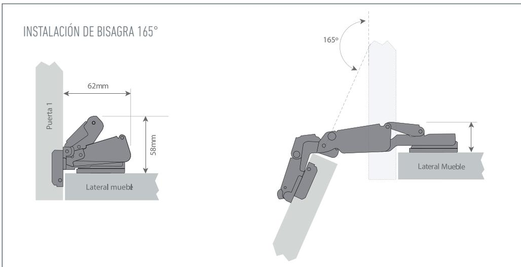
INSTALACIÓN DE BISAGRA 165° + BISAGRA INTERMEDIA
