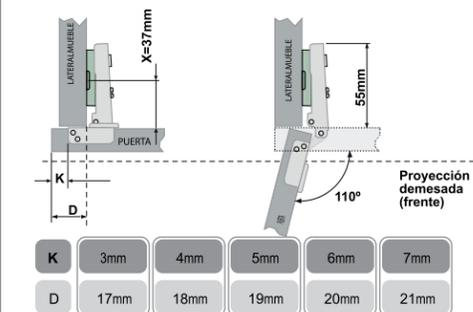
Medida para una correcta instalación del cuerpo y cazoleta de bisagra Semicurva (Codo 9)
