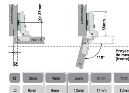
Medida para una correcta instalación del cuerpo y cazoleta de bisagra Curva (Codo 18)
