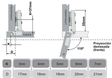
Medida para una correcta instalación del cuerpo y cazoleta de bisagra Semicurva (Codo 9)
