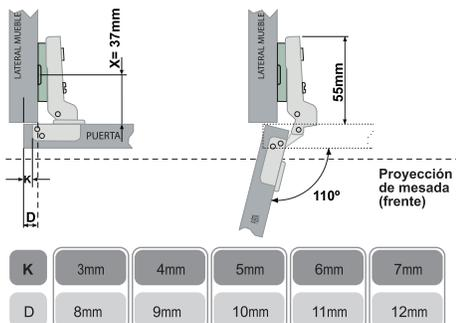
Medida para una correcta instalación del cuerpo y cazoleta de bisagra Curva (Codo 18)
