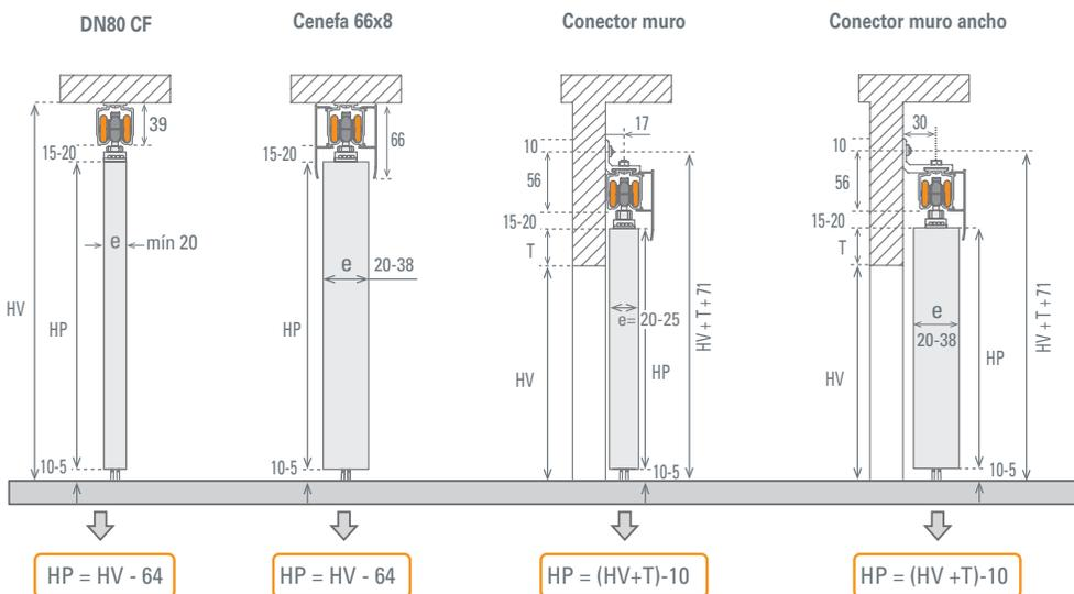
HP= Altura puerta | AP= Ancho puerta | T= Traslape | HV= Altura Vano | AV= Ancho vano
