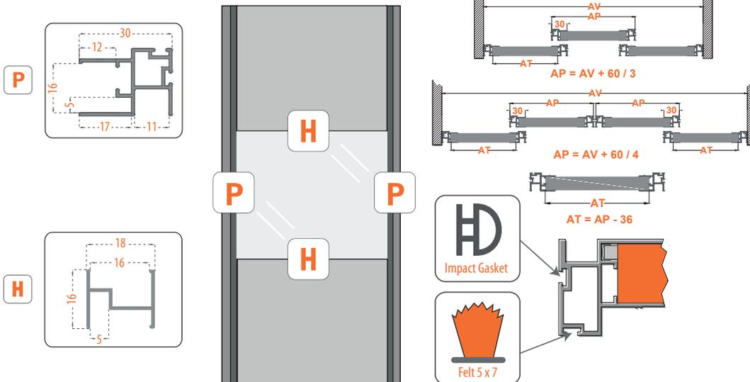
H = altura vano | HP = altura puerta | AV = ancho vano | AP = ancho puerta | AT = ancho de tablero
