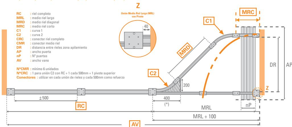
(\*) Zona de ajuste contratuercas (sistema embutido): sólo cuando el sistema de rieles va embutido en el cielo, se debe dejar esta zona libre para poder ajustar la contratuercas de los carros. Puede llevar una tapa de terminación que se pueda sacar en caso de necesitar algún ajuste.
