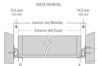
Con el cajón invertido, fije las correderas en la base usando tornillos para madera aglomerada de 3.5 x 16 mm, y para perforaciones menores utilice tornillo madera aglomerada de 3 x 16 mm.
