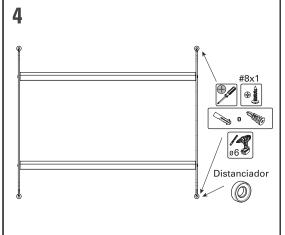
Asegurar sólo la fijación superior derecha. Colocar las bandejas en su posición y fijar la perforación inferior usando un distanciador
