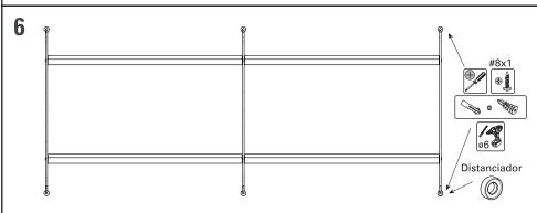
Asegurar sólo la fijación superior derecha. Colocar las bandejas en su posición y fijar la perforación inferior usando un distanciador
