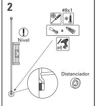
Nivelar verticalmente para definir y fijar la perforación inferior usando un distanciador.
