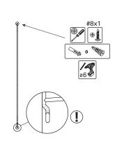
Definir posición del 1er soporte en el muro, marcar perforación superior para luego perforar
