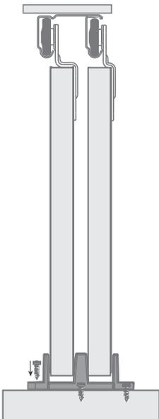
Guía se ajusta a espesor de la madera
